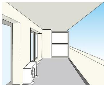
図4-15 目立たない場所への室外機の設置
