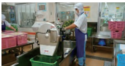
①野菜カット 大量の野菜をスライサーなどでカット
